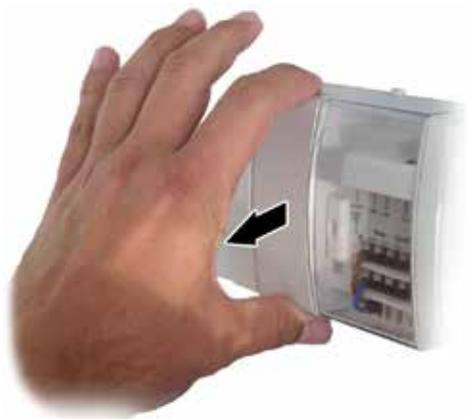
2. Insérez le produit dans le connecteur femelle du module de base Control.
