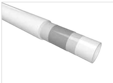
Schlüter-BEKOTEC-THERM-HR est un tube de chauffage à 5 couches en polymère de haute qualité (PE-RT), muni d'une séparation centrale contre la diffusion d'oxygène. Le tube extrêmement souple et conforme à la norme DIN 16833 est spécialement adapté à la pose dans les panneaux à plots BEKOTEC. La barrière anti-oxygène est certifiée conformément à la norme DIN 4726 et est continuellement contrôlée.
