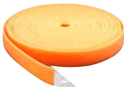
Schlüter-BEKOTEC-BRS est une bande périphérique en mousse de polyéthylène à cellules fermées comportant un film en embase. La bande périphérique se pose sur les parties verticales et l'embase vient se placer sous le panneau BEKOTEC ou sous le film de recouvrement en PE. Ce type de bande convient p. ex. pour des chapes traditionnelles en ciment. La bande périphérique Schlüter-BEKOTEC-BRSK est autocollante pour permettre la fixation au mur.
