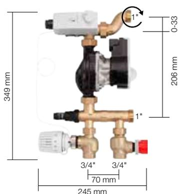
Schlüter-BEKOTEC-THERM-FRS est une station de régulation à valeur fixe pour le réglage de la température de départ. L'installation d'un set de collecteurs de circuits de chauffage (acier inox. ou matière plastique) avec 1 à 12 circuits de chauffage est possible. L'installation peut s'effectuer dans les coffrets pour collecteurs VSE/VSV. La station mélangeuse alimente le plancher chauffant-rafraîchissant BEKOTEC-THERM en basse température de départ nécessaire.
