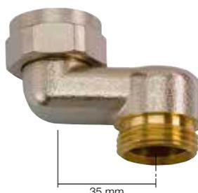
Schlüter-BEKOTEC-THERM-S35 est un raccord en S en laiton nickelé, doté d'un côté d'un écrou-raccord conique 3/4" (DN 20) et d'autre côté d'un embout de raccordement conique 3/4" (DN 20) pour le raccordement des tubes de chauffage Schlüter de 10, 12, 14 ou 16 mm de diamètre.
