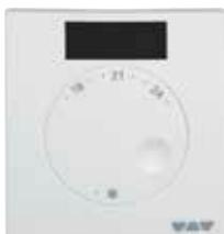
Schlüter-BEKOTEC-THERM-ER/WL est un capteur de température ambiante, à commande radio, pour la régulation du plancher chauffant-rafraîchissant. La valeur souhaitée peut être réglée entre 8 et 30 °C (possibilité de limitation en cas de besoin) et est transmise sans fil au module de raccordement EAR 2/6 WL. L'abaissement de la température est assuré par l'unité de Timer EET. L'alimentation en énergie est effectuée par une cellule solaire intégrée ou par la pile-bouton fournie.
