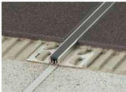
Schlüter-DILEX-KS est un profilé pour joint de fractionnement pour pose collée avec protection des arêtes de carrelage, comportant des ailes de fixation latérales en aluminium ou en acier inoxydable reliées entre elles par une zone pouvant se déformer, interchangeable en matériau synthétique souple.
