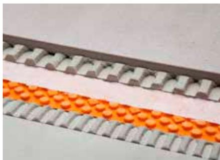
Schlüter-DITRA-DRAIN 4 est une natte en polyéthylène indéformable avec une structure en plots unilatérale et un non-tissé en polypropylène collé sur la face supérieure. Elle s'utilise comme support universel pour des revêtements carrelés en tant que couche de désolidarisation et drainage composite à capillarité passive durablement efficace.
