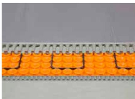
Schlüter-DITRA-HEAT est une natte en polypropylène présentant une structure à plots en queue d'aronde et dotée au dos d'un support non-tissé. Elle s'utilise comme support universel pour des revêtements carrelés et assure les fonctions de désolidarisation, d'étanchéité composite et d'égalisation de la pression de vapeur, et peut recevoir des câbles de chauffage compatibles avec le système pour réaliser une surface chauffée au sol et au mur.
