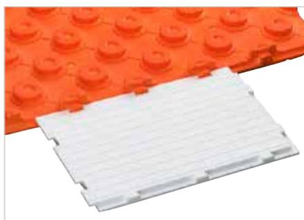
Schlüter-BEKOTEC-ENR est un panneau de compensation permettant d'optimiser les chutes pour les zones de bordure et les passages (par ex. portes, niches) dans lesquels aucun tube de chauffage n'est posé. Il est également possible de l'utiliser devant les collecteurs de chauffage pour faciliter le départ des tuyaux de chauffage.
