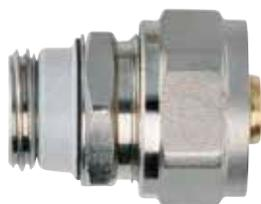
Schlüter-BEKOTEC-THERM-AN est un embout de raccordement en laiton nickelé. D'un côté avec filetage 1/2" (DN 15) auto-étanche et de l'autre côté avec un raccord vissé 3/4" (DN 20) pour le raccordement des tubes de chauffage Schlüter de 14 ou 16 mm – adapté à tous les raccords vissés eurocône.
