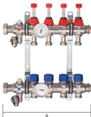
Schlüter-BEKOTEC-THERM-HVT/DE est un set de collecteurs pour circuits de chauffage de DN 25 en acier inoxydable avec rampe de départ et de retour, diamètre 35 mm. Pour le montage, 2 supports de collecteurs avec insert isolant prévus pour le coffret de collecteurs Schlüter ainsi qu'un set de montage mural sont fournis.
