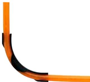
Schlüter-BEKOTEC-THERM-ZW est un coude en matière plastique permettant de cintrer exactement à 90° le tube de Ø 10, 12, 14 mm ou 16 mm au départ du coffret du collecteur. La patte coudée se clipse tout simplement sur le côté du tube. Son utilisation est recommandée du fait de l'épaisseur relativement faible de la chape et facilite le montage dans le coffret du collecteur.
