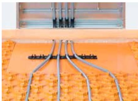
Le panneau lisse Schlüter-BEKOTEC-ENFG se monte dans la zone du collecteur afin de faciliter le montage des tubes de chauffage dans le coffret pour collecteur. Le panneau en polystyrène est fixé sous le panneau à plots à l'aide de la bande adhésive double face fournie (6 m).
