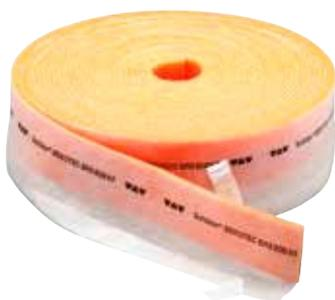
Schlüter-BEKOTEC-BRS/KF est une bande périphérique en mousse de polyéthylène, à cellules fermées, comportant une embase à coller et une bande autocollante pour la fixation au mur. La pose du panneau à plots BEKOTEC sur l'embase à coller en PE permet de réaliser une liaison qui évite aux chapes autolissantes de couler sous le panneau, lors de leur mise en œuvre.
