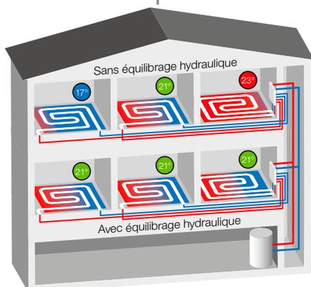
L'équilibrage hydraulique est essentiel pour l'efficacité énergétique des systèmes de chauffage et/ou de rafraîchissement. Il empêche une alimentation déséquilibrée de circuits individuels, garantissant ainsi plus de confort et d'efficacité énergétique. Outre l'équilibrage statique, un équilibrage adaptatif intelligent peut permettre une répartition encore plus optimale de la chaleur. Ses avantages :
