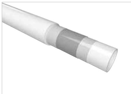
Schlüter-BEKOTEC-THERM-HR est un tube de chauffage à 5 couches en polymère de haute qualité (PE-RT), muni d'une séparation centrale contre la diffusion d'oxygène. Le tube extrêmement souple et conforme à la norme DIN 16833 est spécialement adapté à la pose dans les panneaux à plots BEKOTEC. La barrière anti-oxygène est certifiée conformément à la norme DIN 4726 et est continuellement contrôlée.
