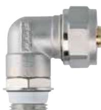
Schlüter-BEKOTEC-THERM-AW est un coude de raccordement en laiton nickelé, en version pivotante. D'un côté avec filetage 1/2" (DN 15) auto-étanche et de l'autre côté avec un raccord vissé 3/4" (DN 20) pour le raccordement du tube de chauffage Schlüter de 14 ou 16 mm.
