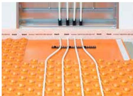
Le panneau lisse Schlüter-BEKOTEC-ENFGK se monte dans la zone du collecteur afin de faciliter le montage des tubes de chauffage dans le coffret pour collecteur. Le panneau en polystyrène est fixé sous le panneau à plots à l'aide de la bande adhésive double face fournie (6 m).
