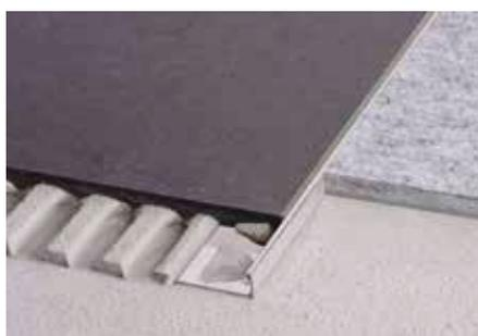
Schlüter-SCHIENE-ES est un profilé de finition en acier inoxydable pour revêtements carrelés ou en pierre naturelle. Il est doté d'un espaceur intégré qui permet de prédéfinir un joint constant entre carreau et profilé. (Fiche produit 1.1)
