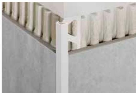
Schlüter-QUADEC-PQ est un profilé de finition en PVC coloré pour angles muraux sortants et bordures de revêtements carrelés. La surface visible du profilé forme un angle droit. Un espaceur permet de prédéfinir le joint entre carreau et profilé. (Fiche produit 2.10)
