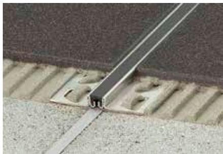
Schlüter-DILEX-KS est un profilé pour joint de fractionnement pour pose collée avec protection des arêtes de carrelage, comportant des ailes de fixation latérales en aluminium ou en acier inoxydable reliées entre elles par une zone pouvant se déformer, interchangeable en matériau synthétique souple. (Fiche produit 4.8)
