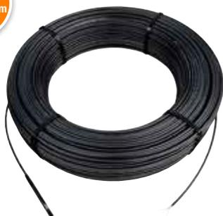
Schlüter-DITRA-HEAT-E-HK est un câble de chauffage électrique doté d'un raccordement à l'une de ses extrémités et destiné à être posé dans la natte de désolidarisation Schlüter-DITRA-HEAT. Le câble a une puissance de 12,5 W/m.
