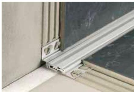
Schlüter-DILEX-BTO est un profilé couvre-joint de dilatation en aluminium pour les transitions sol/mur. La liaison articulée latérale de la partie médiane emboîtée permet d'absorber des mouvements tridimensionnels.
