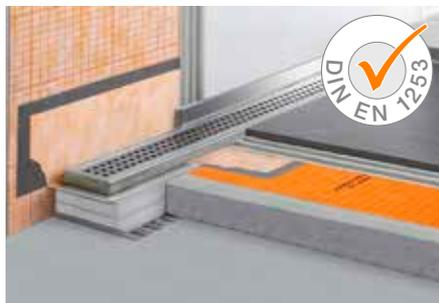
Schlüter-KERDI-LINE-V 50 G2 est un set complet pour douches à l'italienne avec évacuation verticale. Il peut s'utiliser indifféremment pour un montage au centre de la douche ou le long d'un mur. Il dispose selon DIN EN 1253 d'un débit d'évacuation  $\geq 0,8$  l/s et d'une hauteur de garde d'eau du siphon de 50 mm. Pour la sécurité du raccordement à l'étanchéité composite, le rebord du corps de caniveau est doté d'une manchette en Schlüter-KERDI collée en usine.
