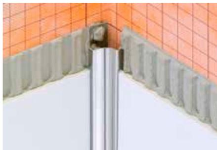
Schlüter-DILEX-HKU est un profilé à gorge creuse entièrement en acier inoxydable, pour la réalisation d'angles rentrants muraux et de raccords sol/mur soumis à des contraintes d'hygiène élevées. Du fait de l'aile de fixation interne, le profilé peut être utilisé pour des épaisseurs de revêtements différentes.
