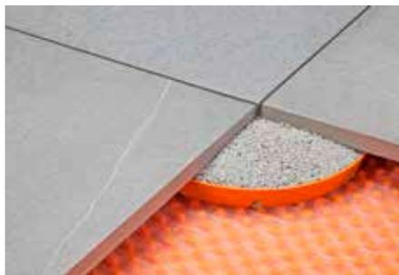
Schlüter-TROBA-STELZ-MR sont des disques de coffrage en polyéthylène qui facilitent la pose des dalles de grand format sur des balcons et terrasses. Ces disques de 25 mm de haut sont posés aux points de jonction des dalles, et remplis de mortier. (Fiche produit 7.3)
