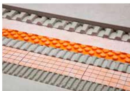
Schlüter-DITRA-DRAIN 4 est une natte en polyéthylène indéformable avec une structure en plots unilatérale et un non-tissé en polypropylène collé sur la face supérieure. Elle s'utilise comme support universel pour des revêtements carrelés en tant que couche de désolidarisation et drainage composite à capillarité passive durablement efficace.
