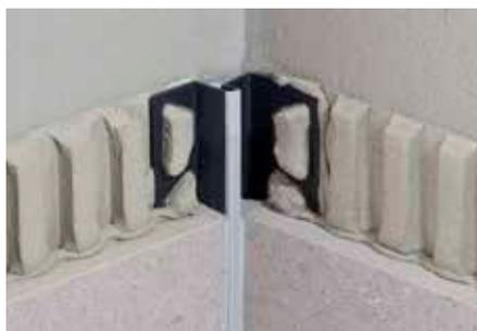
Schlüter-DILEX-EKE est un profilé d'angle souple monobloc en matériau synthétique dur/souple pour angles muraux rentrants ou pour la liaison sol/mur. Le profilé dispose d'une espace disponible pour intégrer le carrelage et peut être posé sur des supports non-flottants.
