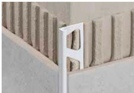
Schlüter-JOLLY-AC est un profilé décoratif en aluminium coloré pour angles muraux sortants, plinthes et bordures. Son aile de finition à 90° protège les carreaux des agressions mécaniques. Les espaceurs permettent de prédéfinir les joints entre carreau et profilé. La forme géométrique du profilé facilite l'ancrage du mortier-joint. Les angles avec aide pour raccords garantissent une finition propre et décorative.
