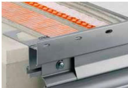
Schlüter-BARA-RTKE est un profilé de rive avec rejeteau, destiné à être posé sur une forme de pente. Le profilé a un dispositif pour la fixation du système de gouttière Schlüter-BARIN. Le profilé BARA-RTKE est particulièrement adapté à la pose en combinaison avec le drainage composite Schlüter-DITRA-DRAIN. Le bord perforé du profilé permet de réaliser une finition soignée du revêtement carrelé.
