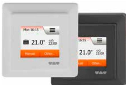
Schlüter-DITRA-HEAT-E-R est un régulateur de température permettant de programmer le système Schlüter-DITRA-HEAT-E. La commande s'effectue depuis l'écran tactile de 2" (5,1 cm). Le régulateur de température commande au choix la température de surface ou la température ambiante selon une programmation. Une sonde de réserve fait partie de la livraison.
