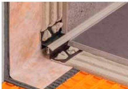
Schlüter-DILEX-EK est un profilé de joint périphérique flexible et durable en matériau synthétique dur/souple muni d'un assemblage à languette et rainure et un espace disponible pour intégrer le carrelage. Il permet de réaliser des joints de bordure durables, souples et sans entretien au niveau des liaisons sol/mur ou sol/plinthe.
