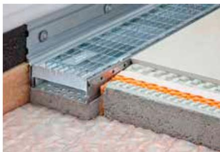
Schlüter-TROBA-LINE-TLR est un caniveau de drainage avec une partie inférieure en acier inoxydable et une grille de drainage supérieure en acier galvanisé. En l'absence de hauteur suffisante pour un relevé d'étanchéité, on l'utilisera afin d'empêcher l'eau de s'accumuler devant les portes et baies des terrasses et balcons. Il peut aussi s'utiliser comme caniveau de drainage de surface supportant des charges élevées. (Fiche produit 7.4)
