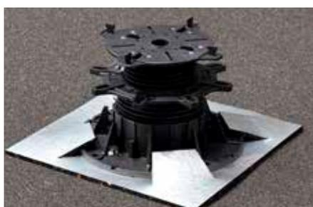
Schlüter-TROBA-LEVEL-PLS 6 sont des patins à base de granulats de caoutchouc, destinés à la protection de l'étanchéité. Les embases de TROBA-LEVEL-PLV 60 ou TROBA-LEVEL-LV 3 doivent être fixées dans les fentes du patin de protection TROBA-LEVEL-PLS 6 (6 mm). Pour des étanchéités en PVC, poser la couche de séparation en alu. du patin de protection vers le bas. Lors de l'utilisation de TROBA-LEVEL-PL 10, positionner ces derniers au milieu des patins.
