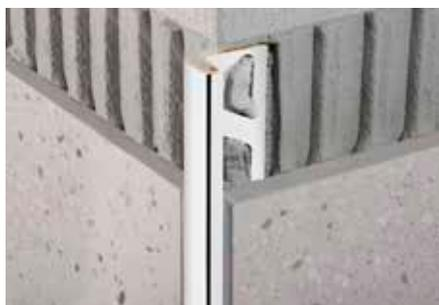
Schlüter-DECO est un profilé avec une surface visible de 6 mm de large pour l'agencement décoratif de joints de revêtements carrelés. Schlüter-DECO-M et -MC peuvent être utilisés comme profilés de finition pour angles sortants de murs. Les profilés Schlüter-DECO en aluminium, en laiton et en acier inoxydable conviennent aussi pour l'agencement de revêtements de sol.
