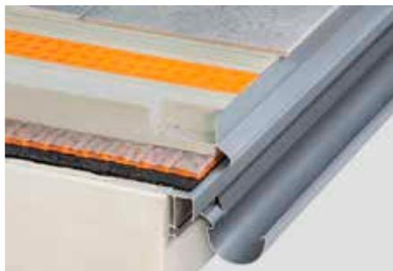
Schlüter-BARA-RK est un profilé de rive pour balcons en forme de T. Le débord forme un rejetau couvrant l'espace créé par le drainage de surface TROBA.
