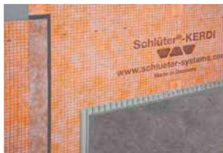
Schlüter-KERDI est une natte d'étanchéité en polyéthylène dont les deux faces sont revêtues d'un non-tissé permettant un ancrage efficace dans le mortier-colle. Elle est adaptée notamment pour les protections à l'eau en extérieur réalisées en dessous des drainages de surface à l'aide de Schlüter-TROBA-PLUS ou des drainages composites avec Schlüter-DITRA-DRAIN.
