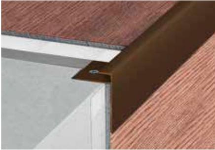
Schlüter-VINPRO-STEP-R est un profilé de finition et d'arêtes pour revêtements souples (p. ex. LVT, revêtements design) dans les escaliers. La partie supérieure du profilé présente une aile inclinée et arrondie de 10 mm d'épaisseur, destinée à cacher l'arête du revêtement souple.
