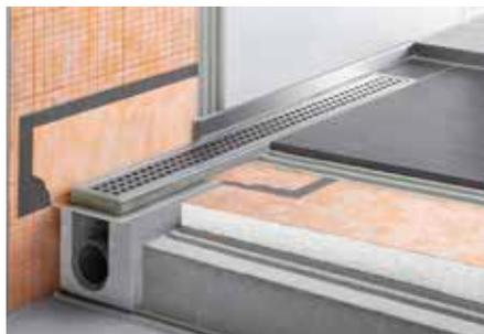
Schlüter-KERDI-LINE-H est un set complet pour douches à l'italienne, avec évacuation horizontale. Il peut s'utiliser indifféremment pour un montage au centre de la douche ou le long d'un mur. Le rebord du caniveau est doté d'une manchette Schlüter-KERDI collée en usine. Elle assure le raccordement du corps de caniveau avec l'étanchéité composite, tant au niveau du sol que des murs adjacents.
