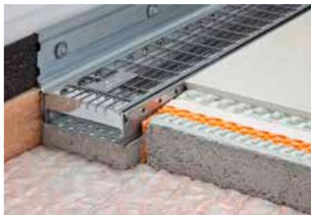
Schlüter-TROBA-LINE-TLR-E est un caniveau de drainage avec grille en acier inoxydable poli. En l'absence de hauteur suffisante pour un relevé d'étanchéité, on l'utilisera afin d'empêcher l'eau de s'accumuler devant les portes et baies des terrasses et balcons. Il peut aussi s'utiliser comme caniveau de drainage de surface supportant des charges élevées.
