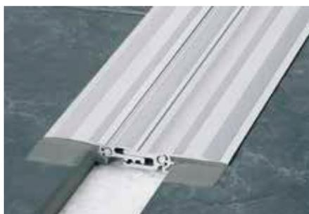
Schlüter-DILEX-BTS est un profilé couvre-joint de dilatation en aluminium pour le montage ultérieur dans des revêtements déjà réalisés. La liaison articulée latérale de la partie médiane emboîtée permet d'absorber des mouvements tridimensionnels.
