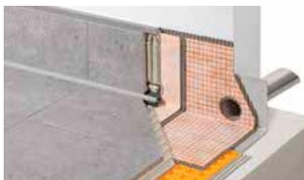
Schlüter-KERDI-DRAIN-SP-E est une gargouille en acier inoxydable pour l'évacuation de l'eau des surfaces de balcons et terrasses entourés d'un mur ou d'un muret. La manchette Schlüter-KERDI en tant que raccord d'étanchéité se colle sur la platine, garantissant ainsi une liaison simple et sûre des étanchéités composites.
