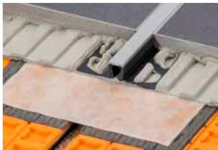
Schlüter-DILEX-BWB est un profilé de fractionnement pour pose collée avec des parties latérales en matière synthétique, recyclée, rigide. La partie supérieure en matière plastique souple présente une surface visible de 10 mm de largeur.
