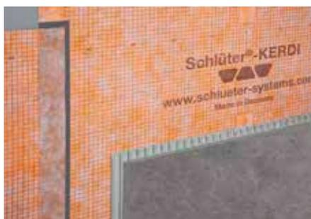
Schlüter-KERDI est une natte d'étanchéité en polyéthylène dont les deux faces sont revêtues d'un non-tissé permettant un ancrage efficace dans le mortier-colle. Cette natte peut notamment être mise en œuvre en combinaison avec des revêtements carrelés, au sol (sur chape) ou au mur. Grâce à sa haute résistance à la diffusion d'eau, la natte Schlüter-KERDI-DS peut être utilisée comme film pare-vapeur en combinaison avec des revêtements carrelés.
