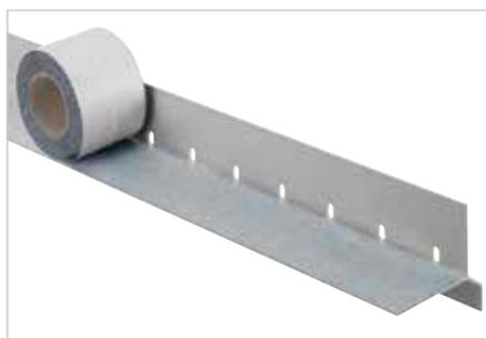
Schlüter-BARA-HV est un ruban adhésif d'accrochage en polyéthylène doté d'un non-tissé sur sa face supérieure et d'une couche de butyle autocollante sur sa face inférieure. Il permet de créer un flasque à coller pour un raccordement parfait de l'étanchéité composite Schlüter-KERDI à une bordure réalisée avec Schlüter-BARA-RKL.
