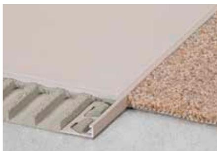
Schlüter-SCHIENE-AC est un profilé décoratif en aluminium coloré. Son aile de finition à 87° protège les carreaux des agressions mécaniques. Un espaceur permet de prédéfinir le joint entre carreau et profilé.
