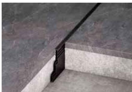
Schlüter-DILEX-MP est un profilé de fractionnement pour pose scellée. Il est composé de parois latérales en PVC dur recyclé, découpées en queue d'aronde, et d'une zone de dilatation en CPE souple. La hauteur est réglée au moyen de rehausseuses.
