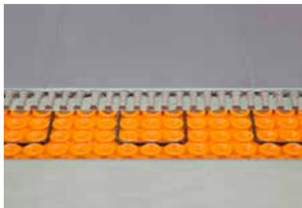
Schlüter-DITRA-HEAT-PS est une natte en polypropylène présentant une structure à plots en queue d'aronde et dotée au dos d'un support non-tissé autocollant. Après avoir retiré le film protecteur, vous pouvez poser DITRA-HEAT-PS sur tout support adapté sans utiliser de mortier-colle. La natte est imperméable à l'eau et sert de support pour la fixation des câbles de chauffage, de désolidarisation et d'égalisation de la pression de vapeur. (Fiche produit 6.5)
