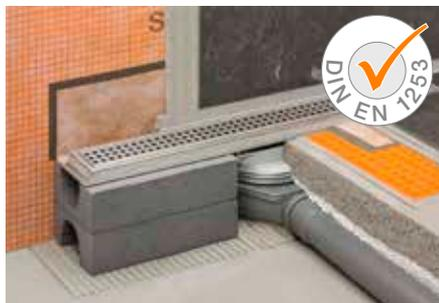
Schlüter-KERDI-LINE-H 50 G2 est un set complet pour douches à l'italienne avec évacuation horizontale. Il peut s'utiliser indifféremment pour un montage au centre de la douche ou le long d'un mur. Il dispose selon DIN EN 1253 d'un débit d'évacuation  $\geq 0,8$  l/s et d'une hauteur de garde d'eau du siphon de 50 mm. Pour la sécurité du raccordement à l'étanchéité composite, le rebord du corps de caniveau est doté d'une manchette en Schlüter-KERDI collée en usine.
