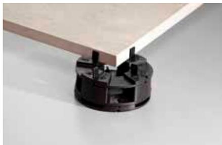
Schlüter-TROBA-LEVEL-PLA 30 sont des rehausses pour les supports de dalles. A partir d'une hauteur de structure de 50 mm, il est possible d'utiliser une ou plusieurs rehausses TROBA-LEVEL-PLA 30 entre deux supports de dalles Schlüter-TROBA-LEVEL-PL 10. TROBA-LEVEL-PLA 30 peuvent être superposés jusqu'à une hauteur de 300 mm et sont combinables avec les supports de dalles TROBA-LEVEL-PLV 60 et TROBA-LEVEL-LV 3.
