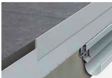
Schlüter-BARA-RHA est un profilé de recouvrement réglable en hauteur en aluminium coloré. En liaison avec des profilés-soutiens correspondants, comme p. ex. BARA-RWL ou BARA-RKL, il permet de délimiter les bordures libres de balcons et de terrasses. Ainsi, un recouvrement de structures allant jusqu'à 220 mm de hauteur peut être réalisé.
