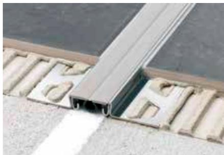
Schlüter-DILEX-KSBT est un profilé couvre-joint de dilatation en aluminium ou en acier inoxydable, avec une zone de déformation de 20 ou 30 mm de largeur en caoutchouc synthétique souple.
