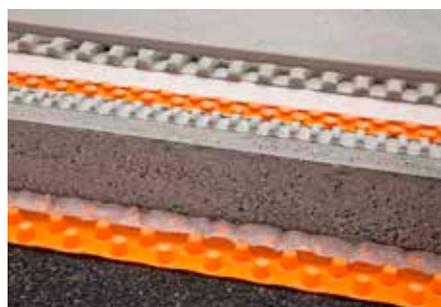
Schlüter-TROBA-PLUS est une natte de drainage à capillarité passive assurant une évacuation durable et efficace des infiltrations d'eau. Les plots coniques très rapprochés supportent des charges élevées et sont recouverts d'un non-tissé perméable. Ces plots assurent le soutien du revêtement sur toute sa surface et ménagent ainsi un espace de drainage continu.
