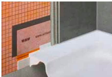
Schlüter-KERDI-TS est un set permettant de garantir un raccord étanche entre des éléments fixes (baignoires et receveurs de douche en acier émaillé, en acrylique ou en composite, selon DIN 18534-1) et le système d'étanchéité Schlüter-KERDI. Il comprend une bande d'étanchéité en polyéthylène, revêtue de non-tissé sur les deux faces, une bande d'isolation phonique autocollante ainsi que le matériel de montage.
