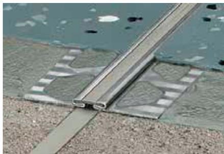
Schlüter-DILEX-EKSB est un profilé pour joint de fractionnement avec protection d'arête pour les revêtements de sol de faible épaisseur. Il se compose d'ailes de fixation latérales en acier inoxydable reliées par une zone de dilatation, non interchangeable, en plastique souple.
