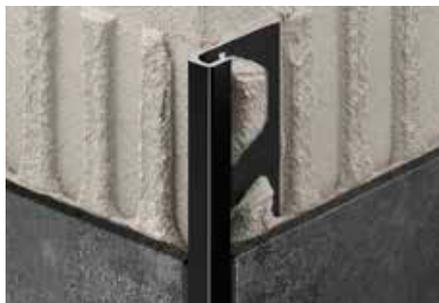
Schlüter-QUADEC-AC est un profilé de finition de haute qualité, en aluminium coloré, pour angles muraux sortants et bordures de revêtements carrelés. La surface visible du profilé forme un angle droit. Un espaceur permet de prédéfinir le joint entre carreau et profilé. (Fiche produit 2.10)
