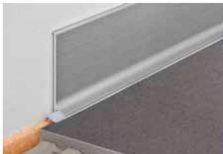
Schlüter-DESIGNBASE-SL-A est un profilé en aluminium anodisé, alu. finition inox. anodisé ou coloré, de haute qualité, permettant de réaliser rapidement des plinthes esthétiques. Le profilé se fixe simplement à l'aide d'une colle adéquate au niveau du mur. Le profilé peut être équipé en option d'une lèvres d'étanchéité afin de protéger le joint de bordure contre la pénétration d'humidité et de réduire la transmission des bruits de chocs.
