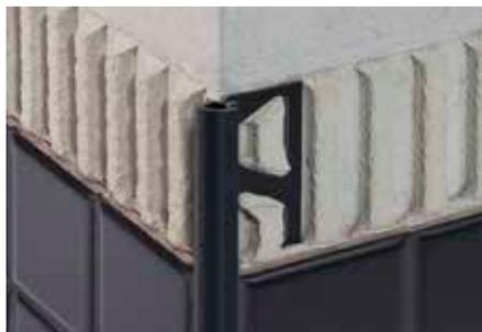
Schlüter-RODEC-PRO est un profilé décoratif en PVC pour angles muraux sortants, plinthes et bordures. Il présente un arrondi symétrique destiné à protéger les arêtes du carrelage des agressions mécaniques. Un espaceur permet de prédéfinir le joint entre carreau et profilé.
