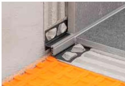
Schlüter-DILEX-RF est un profilé en deux parties en matériau synthétique dur/souple avec assemblage à rainure et languette pour des joints de bordure durablement souples au niveau des liaisons sol/mur ou au niveau des plinthes.
