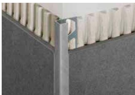
Schlüter-QUADEC-A est un profilé de finition de haute qualité, en aluminium anodisé, pour angles muraux sortants et bordures de revêtements carrelés. La surface visible du profilé forme un angle droit. Un espaceur permet de prédéfinir le joint entre carreau et profilé. (Fiche produit 2.10)
