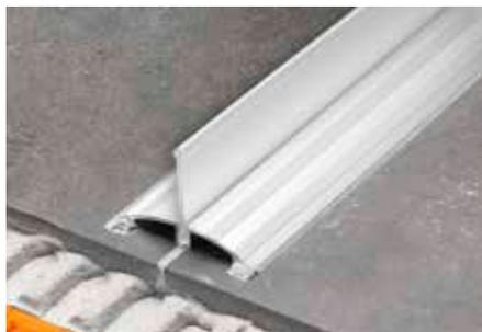
Schlüter-SHOWERPROFILE-WSK est un profilé en aluminium anodisé en deux parties pour la protection anti-débordement dans des douches à l'italienne. Le profilé-support se colle ultérieurement sur des revêtements existants. Il peut être doté, au choix, d'une lèvre droite ou en demi-lune pour la protection contre les débordements. Les deux variantes sont adaptées au franchissement en fauteuil roulant.
