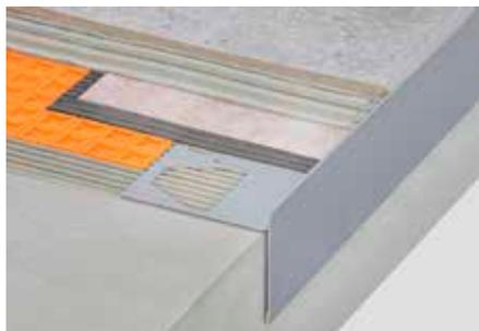
Schlüter-BARA-RT est un profilé de rive en T, en aluminium coloré, pour la délimitation des surfaces de balcons et terrasses. L'aile de finition supérieure recouvre l'arête du revêtement et l'aile inférieure forme un rejetau et cache l'évacuation du drainage de surface TROBA. (Fiche produit 5.19)
