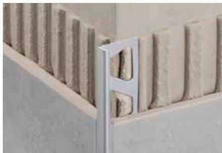
Schlüter-JOLLY est un profilé décoratif en métal pour angles muraux sortants, plinthes et bordures. Son aile de finition à 90° protège les carreaux des agressions mécaniques. Les espaceurs permettent de prédéfinir les joints entre carreau et profilé. La forme géométrique du profilé facilite l'ancrage du mortier-joint. Les angles avec aide pour raccords garantissent une finition propre et décorative. (Fiche produit 2.3)
