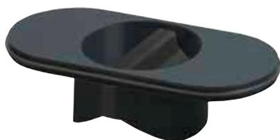
Schlüter-KERDI-LINE-GTO est un siphon avec un clapet anti-retour en silicone. Il peut être mis en œuvre dans les évacuations servant peu souvent (p. ex. dans les maisons de vacances), en remplacement d'un siphon traditionnel. Son débit d'évacuation de 0,4 l/s minimum permet sa mise en œuvre dans tout type d'installation, y compris dans des résidences principales.
