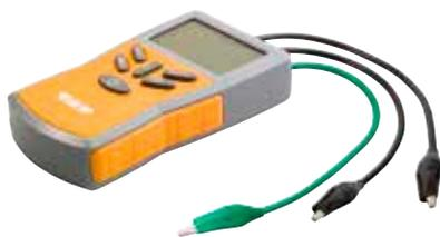
Schlüter-DITRA-HEAT-E-CT est un testeur pour la mesure et le contrôle de la résistance du câble de chauffage électrique Schlüter-DITRA-HEAT-E-HK et -CHC ainsi que des sondes déportées fournies avec les régulateurs Schlüter-DITRA-HEAT-E. Pendant toute la phase de montage, l'appareil surveille la résistance des câbles de chauffage. En cas de dommage, l'appareil est averti par un signal sonore.
