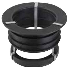
Schlüter-KERDI-DRAIN-ZBS est un joint de traversée avec fonction de protection anti-feu. En lieu et place d'un comblement au mortier, il peut être combiné au set d'évacuation au sol vertical KD BAV 50 GVB ou au set de caniveau avec évacuation verticale KLV 50 G2 comme cloisonnement pare-feu pour les carottages (Ø 160 mm) et évite l'apparition de ponts phoniques. Ne fonctionne qu'en liaison avec l'insert pare-feu KD BS ou KL BS.
