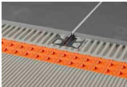
Schlüter-DILEX-FCS est un profilé de mouvements avec ailettes de fixation latérales en PVC rigide recyclé. La largeur de sa partie visible est d'environ 3,5 mm ; il se pose sans laisser d'espace le long du profilé et sans joint de ciment. La protection intégrée est retirée après la pose du carrelage pour accueillir l'insert Schlüter-DILEX-FIS.
