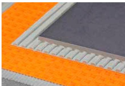
Schlüter-DITRA est une membrane en polypropylène avec des creux carrés contre-dépouillés au design Easyfill, pourvue au verso d'un voile non-tissé de renfort. Elle s'utilise comme support universel pour des revêtements carrelés en tant que couche de désolidarisation, étanchéité composite et égalisation de la pression de vapeur.
