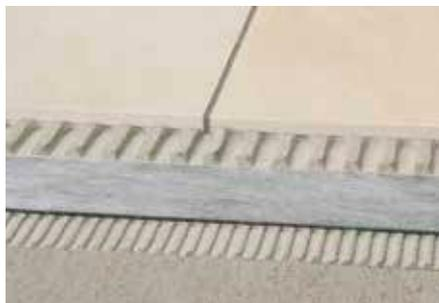
Schlüter-DITRA-SOUND est une couche de qualité lourde à base de polyéthylène recouverte de non-tissé pour l'ancrage dans le mortier-colle. En liaison avec les revêtements carrelés, DITRA-SOUND est une isolation acoustique composite pour le sol.
