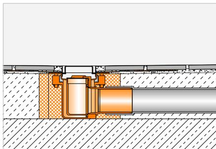
Schlüter-KERDI-LINE-G3 est un caniveau d'évacuation linéaire en acier inoxydable à faible hauteur de structure. Ce caniveau est doté d'une évacuation centrale, latérale ou double et monté soit le long d'un mur soit au centre de la douche. Comme tous les caniveaux d'évacuation Schlüter, il est muni d'une manchette Schlüter-KERDI collée en usine, permettant un raccord fiable à l'étanchéité composite.
