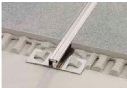
Schlüter-DILEX-EDP est un profilé pour joint de fractionnement pour pose collée, en acier inoxydable permettant d'absorber des mouvements horizontaux grâce à un assemblage languette et rainure.
