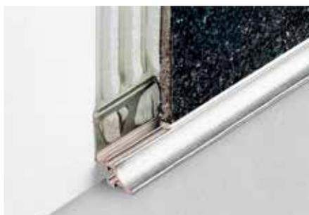
Schlüter-DILEX-AHKA est un profilé à gorge en aluminium pour angles rentrants de murs, plans de travail de cuisine ou étagères, destinés à recevoir un revêtement céramique. Il est disponible avec différentes finitions anodisées ou en aluminium coloré et peut se raccorder d'un côté à des éléments fixes.
