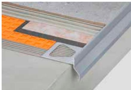
Schlüter-BARA-RKK est un profilé de rive en T avec rejeteau court, destiné à être posé sur une forme de pente. Il est conçu pour une structure avec étanchéité composite Schlüter-DITRA. Le bord fermé du profilé permet de réaliser une finition soignée du revêtement carrelé.
