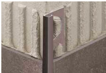
Schlüter-QUADEC-TS est un profilé de finition de haute qualité, en aluminium, doté d'une finition structurée, pour angles muraux sortants et bordures de revêtements carrelés. La surface visible du profilé forme un angle droit. Un espaceur permet de prédéfinir le joint entre carreau et profilé. (Fiche produit 2.10)
