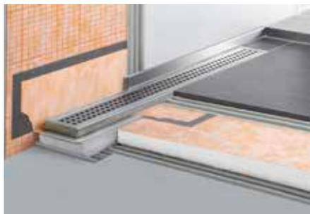
Schlüter-KERDI-LINE-V est un set complet pour douches à l'italienne, avec évacuation verticale. Il peut s'utiliser indifféremment pour un montage au centre de la douche ou le long d'un mur. Le rebord du caniveau est doté d'une manchette Schlüter-KERDI collée en usine. Elle assure le raccordement du corps de caniveau avec l'étanchéité composite, tant au niveau du sol que des murs adjacents. (Fiche produit 8.7)
