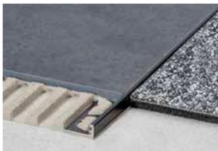
Schlüter-SCHIENE-TS est un profilé décoratif en aluminium à finition structurée adaptée aux designs de carreaux courants. Son aile de finition à 87° protège les carreaux des agressions mécaniques. Un espaceur permet de prédéfinir le joint entre carreau et profilé.
