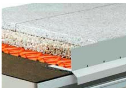
Schlüter-BARA-RKL est un profilé de rive en équerre en aluminium coloré avec orifices d'évacuation de l'eau. Il convient pour des dalles de grand format posées au choix sur les lits de gravier/de concassé sans liant ou sur un système de plots.
