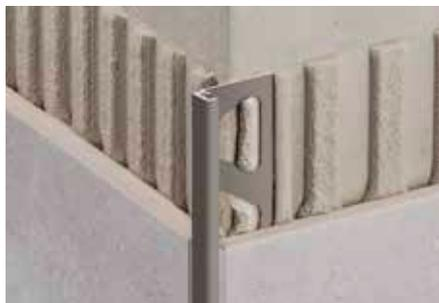
Schlüter-JOLLY-TS est un profilé décoratif pour angles muraux sortants, plinthes et bordures. Son aile de finition à 90° protège les carreaux des agressions mécaniques. Le profilé en aluminium est recouvert d'une finition structurée spéciale. Les espaceurs permettent de prédéfinir les joints entre carreau et profilé. La forme géométrique du profilé facilite l'ancrage du mortier-joint. Les angles avec aide pour raccords garantissent une finition propre et décorative.
