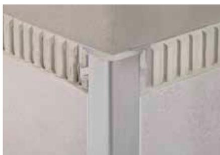
Schlüter-ECK-E est un profilé d'angle sortant en acier inoxydable pour revêtements carrelés. Il offre une très bonne protection des arêtes soumises à de fortes sollicitations. Les ailes de fixation perforées seront noyées lors de la pose du carrelage dans le mortier-colle. (Fiche produit 2.6)
