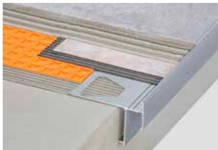
Schlüter-BARA-RAKEG est un profilé de rive avec rejeteau, destiné à être posé sur une forme de pente. Le profilé est adapté à la pose en combinaison avec la natte de désolidarisation Schlüter-DITRA. Le bord fermé du profilé permet de réaliser une finition soignée du revêtement carrelé.
