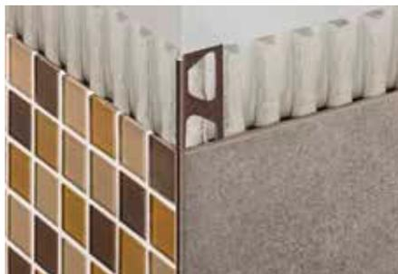
Schlüter-FINEC-TS est un profilé de finition de haute qualité, en aluminium doté d'une finition structurée, pour angles muraux sortants de revêtements céramiques, mosaïques de verre ou de surfaces enduites spatulées. Le profilé protège les bords du revêtement des agressions mécaniques, tout en formant un angle étroit et élégant.
