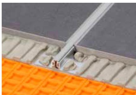
Schlüter-DILEX-AKWS est un profilé pour joint de fractionnement pour pose collée, comportant des ailes de fixation latérales en aluminium avec une zone de mouvement en PVC souple.
