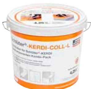
Schlüter-KERDI-COLL-L est une colle étanche bi-composant : une dispersion acrylique exempte de solvant et une poudre réactive à base de ciment. Elle permet le collage et l'étanchéité des chevauchements de bandes Schlüter-KERDI. De plus, KERDI-COLL-L est utilisée pour le pontage étanche des lés et des raccords des bandes d'étanchéité Schlüter-KERDI-KEBA sur une étanchéité composite des produits appropriés de Schlüter-Systems, ainsi que pour le collage sur les profilés de rive Schlüter-BARA.
