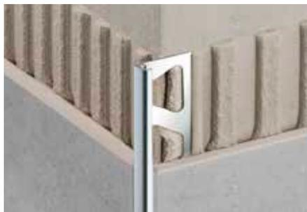
Schlüter-JOLLY-A est un profilé décoratif en aluminium anodisé pour angles muraux sortants, plinthes et bordures. Son aile de finition à 90° protège les carreaux des agressions mécaniques. Les espaceurs permettent de prédéfinir les joints entre carreau et profilé. La forme géométrique du profilé facilite l'ancrage du mortier-joint. Les angles avec aide pour raccords garantissent une finition propre et décorative.
