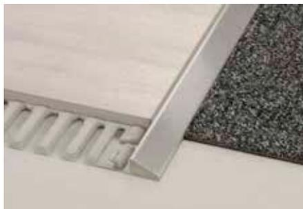
Schlüter-RENO-U est un profilé permettant de réaliser une transition entre des revêtements de sols de hauteurs différentes. Un espaceur permet de prédéfinir le joint entre carreau et profilé. Les profilés Schlüter-RENO-EU, -EBU et -MU ne possèdent pas d'espaceur. (Fiche produit 1.2)
