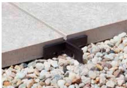
Schlüter-TROBA-ZFK sont des croisillons permettant de réaliser des joints constants lors de la pose libre d'éléments en céramique, de dalles en pierre naturelle ou en béton sur un lit de gravier ou de gravillon, par exemple sur Schlüter-TROBA. La largeur des joints est de 3 mm et la hauteur des croisillons est de 15 mm. Il est possible d'atteindre une hauteur de 30 mm en clipsant les croisillons l'un sur l'autre.
