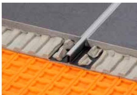
Schlüter-DILEX-BWS est un profilé de fractionnement pour pose collée avec des parties latérales en matière synthétique, recyclée, rigide. La partie supérieure en matière plastique souple présente une surface visible de 5 mm de largeur.
