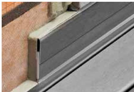
Schlüter-SHOWERPROFILE-R est un profilé de raccordement mural, en deux parties, pour la liaison avec le mur dégagé par la pente, au-dessus du caniveau d'évacuation. La surface visible du profilé est en inox V4A brossé ou à finition structurée. Il est doté au dos d'un non-tissé pour l'ancrage dans le mortier-colle. Grâce à sa conception en deux parties, SHOWERPROFILE-R peut être adapté en hauteur de 23 à 45 mm (existe en deux versions).
