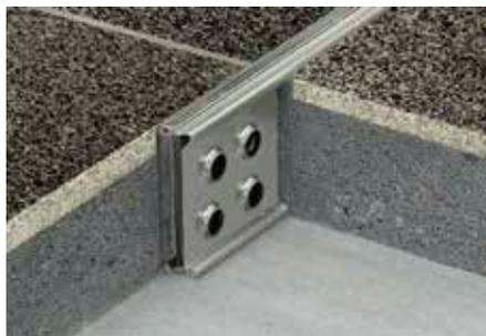
Schlüter-DILEX-EMP est un profilé pour joint de fractionnement en acier inoxydable pour pose scellée, permettant d'absorber des mouvements horizontaux à l'aide d'une liaison languette et rainure.
