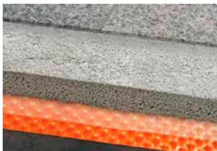
Schlüter-TROBA-PLUS-G est une natte de drainage à capillarité passive assurant une évacuation durable et efficace de l'eau d'infiltration. Les plots coniques très rapprochés supportent des charges élevées et sont recouverts d'un treillis en nylon. Ils assurent le soutien du revêtement sur toute sa surface et ménagent ainsi un espace de drainage continu. Schlüter-TROBA-PLUS 8G est particulièrement adapté pour une utilisation en combinaison avec des chapes drainantes. (Fiche produit 7.2)
