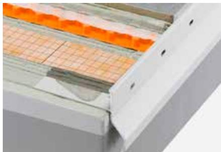
Schlüter-BARA-RKKE est un profilé de rive en T avec rejeteau court, destiné à être posé sur une forme de pente. Le profilé BARA-RKKE convient idéalement pour réaliser une structure en liaison avec le drainage composite Schlüter-DITRA-DRAIN. Le bord perforé du profilé permet de réaliser une finition soignée du revêtement carrelé.
